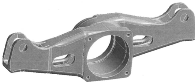
Рис. 1. Общий вид корпуса буксы трехосной тележки модели 18-522А
