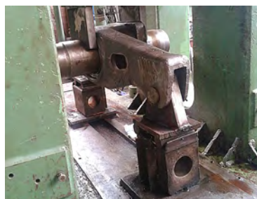
Рис. 2. Общий вид усталостных испытаний корпуса буксы
