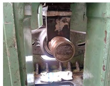
Рис. 2. Общий вид усталостных испытаний корпуса буксы
