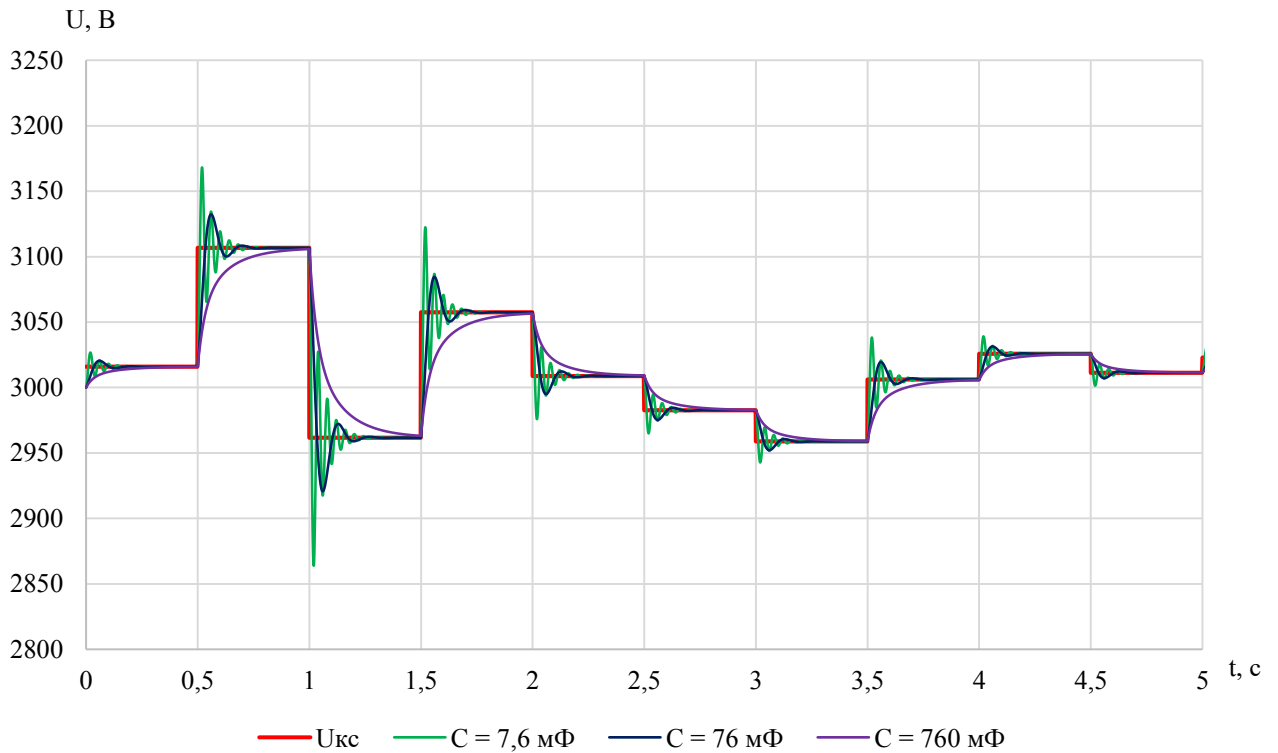
Рисунок 4.11 – Фильтрация входного скачкообразного напряжения контактной сети в зависимости от значения емкости
