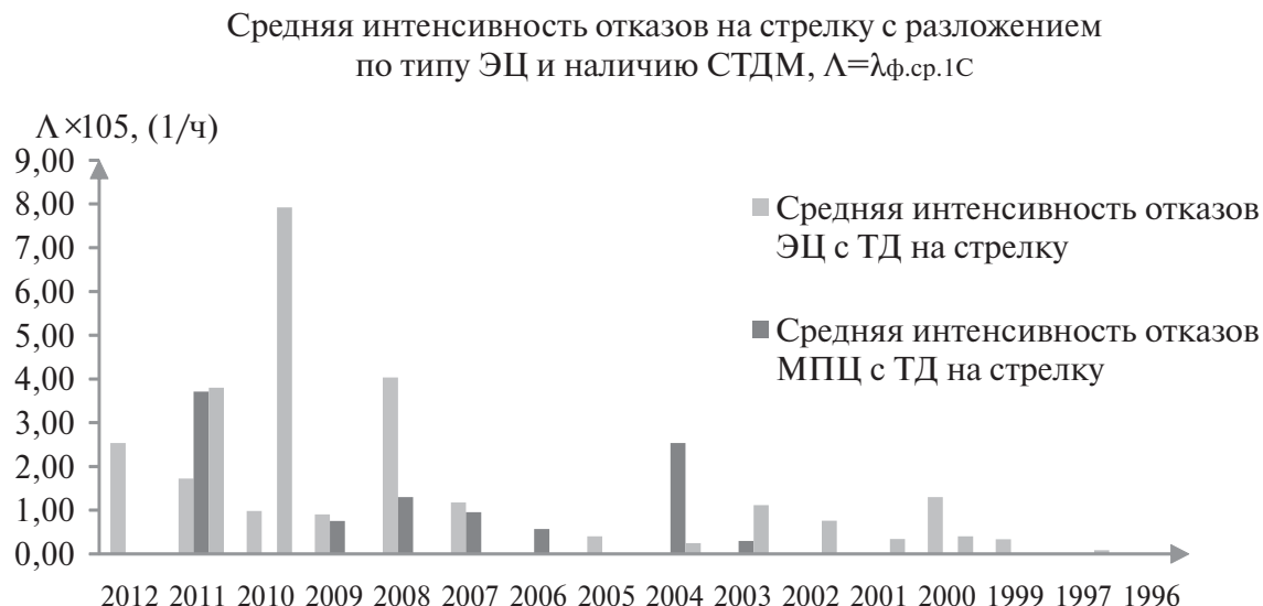
Рис. 4. Средняя интенсивность отказов на стрелку с разложением по типу ЭЦ и наличию СТДМ
