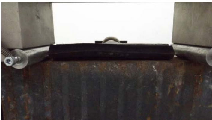
Рис. 12. «Выдавливание» прокладки из узла крепления
