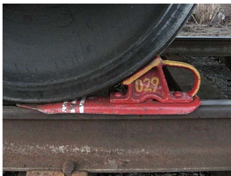
Рис. 1. Ручной тормозной башмак [2]
