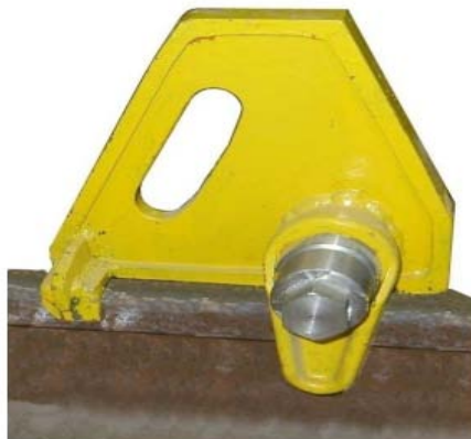
Рис. 2. Общий вид упора УЗ-220 [4]
