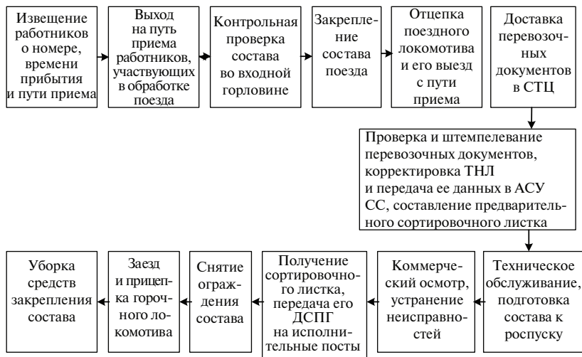
Рис. 1. Структурная схема обработки составов по прибытии в парк приема
