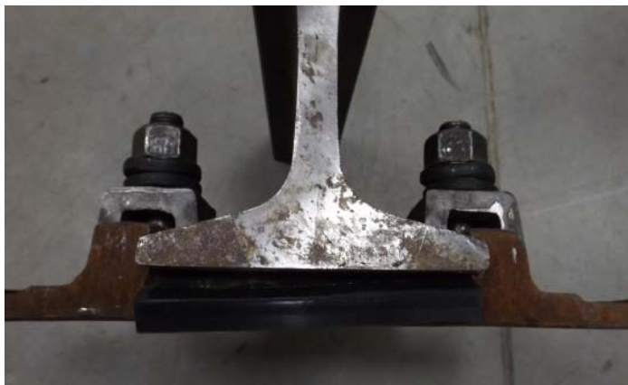
Рис. 11. «Выдавливание» прокладки из узла крепления
