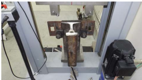
Рис. 9. Рельс и крепление в сборе на испытательной установке
