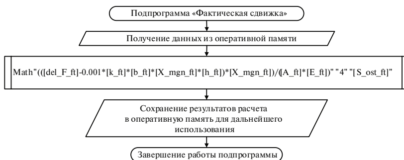
Рис. 6. Блок-схема подпрограммы «Фактическая сдвигка»
