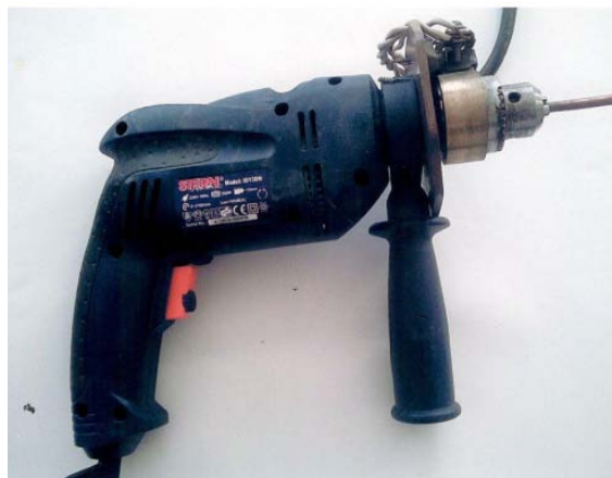
Рис. 2. Установка для электроэрозионной прошивки отверстий
